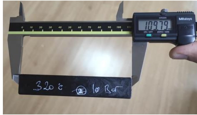
Şekil 4. Plastik Numunenin Ölçüsel Hata Kontrolü
