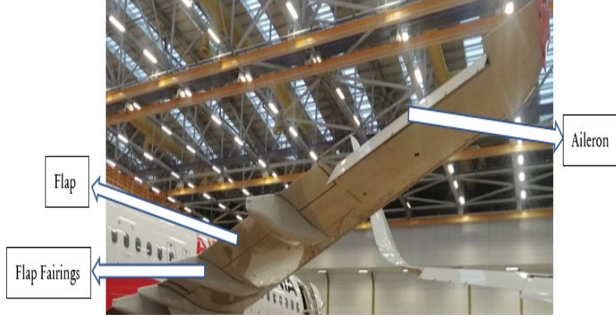
Şekil 4. Uçak kanat yapısının genel yapısı.
