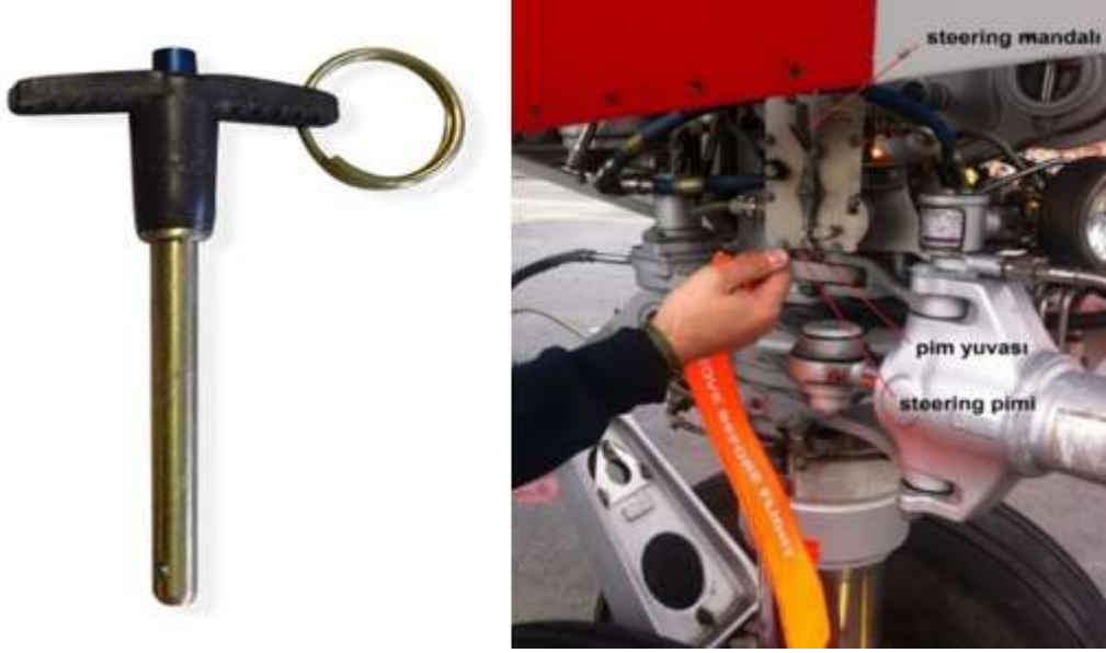
Şekil 12. Steering Pimi ve mekanizması
